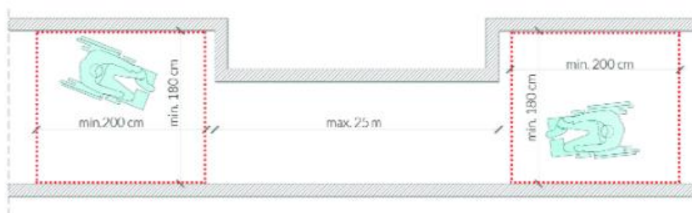
Rys. 26. Poszerzenia ciągów komunikacyjnych niezbędnych do minięcia się dwóch wózków
