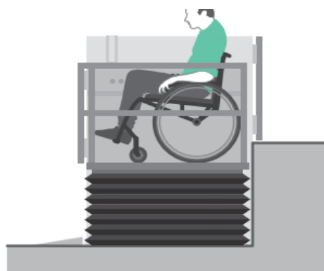
Podnośnik pionowy z kolnierzem gumowym zabezpieczającym przed wejściem pod urządzenie.
