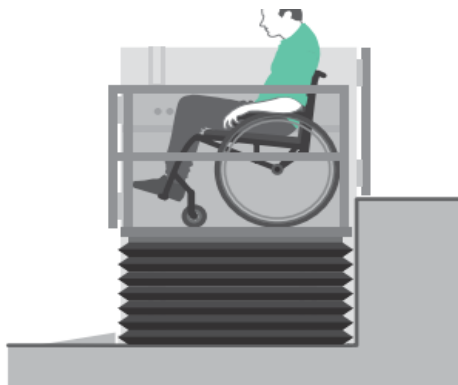
Podnośnik pionowy z kołnierzem gumowym zabezpieczającym przed wejściem pod urządzenie.
